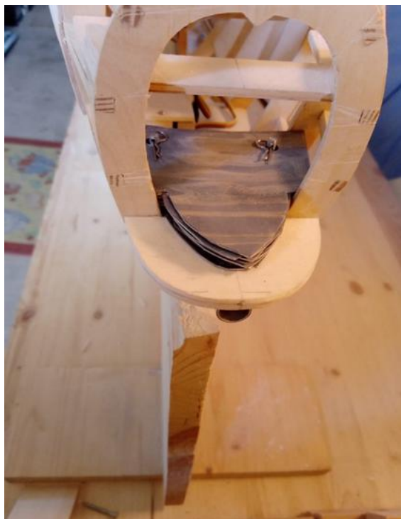
Philippe installe également des plaques de plomb amovibles, en prévision du centrage. Une bonne idée à retenir qui vous évitera un futur "charcutage" du modèle.
