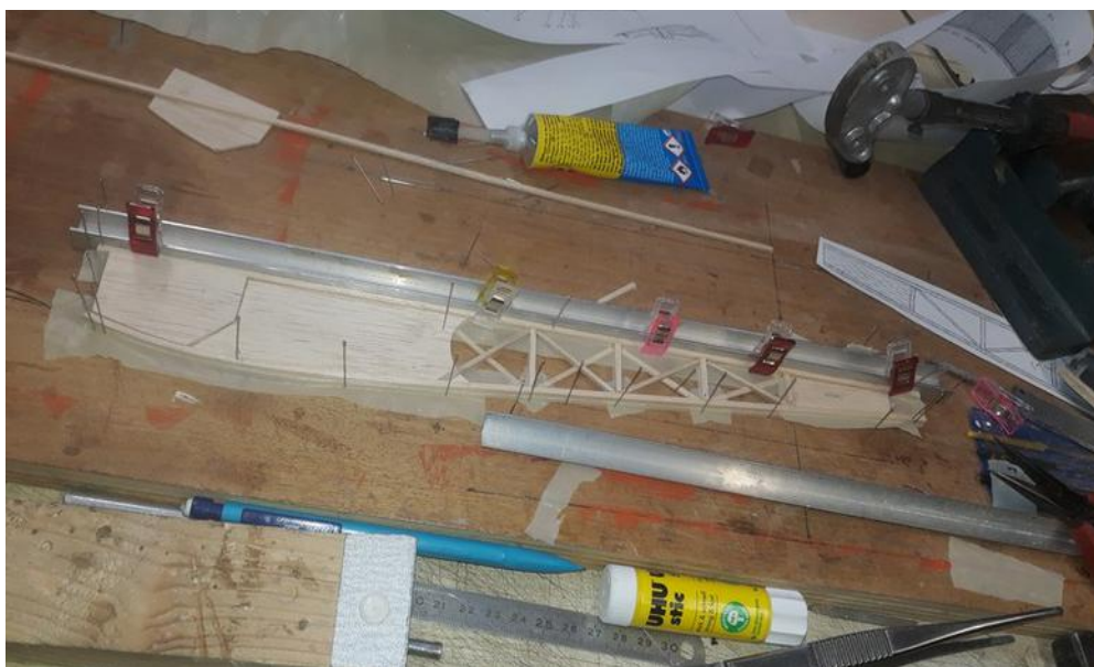
Les deux moitiés du fuselage sont en cours de séchage.
