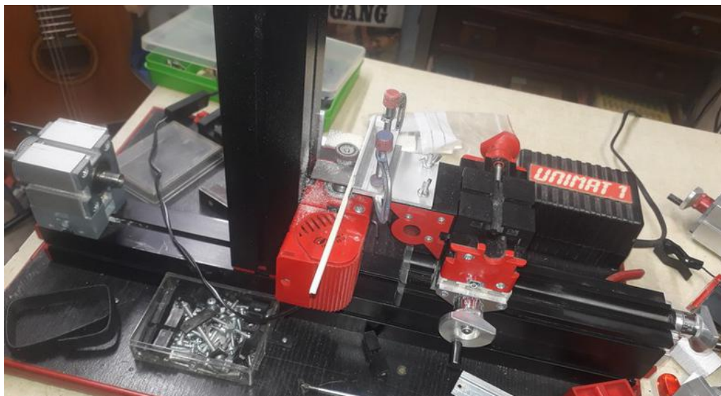
J'ai imaginé ce montage afin de calibrer les baguettes à la bonne cote.
