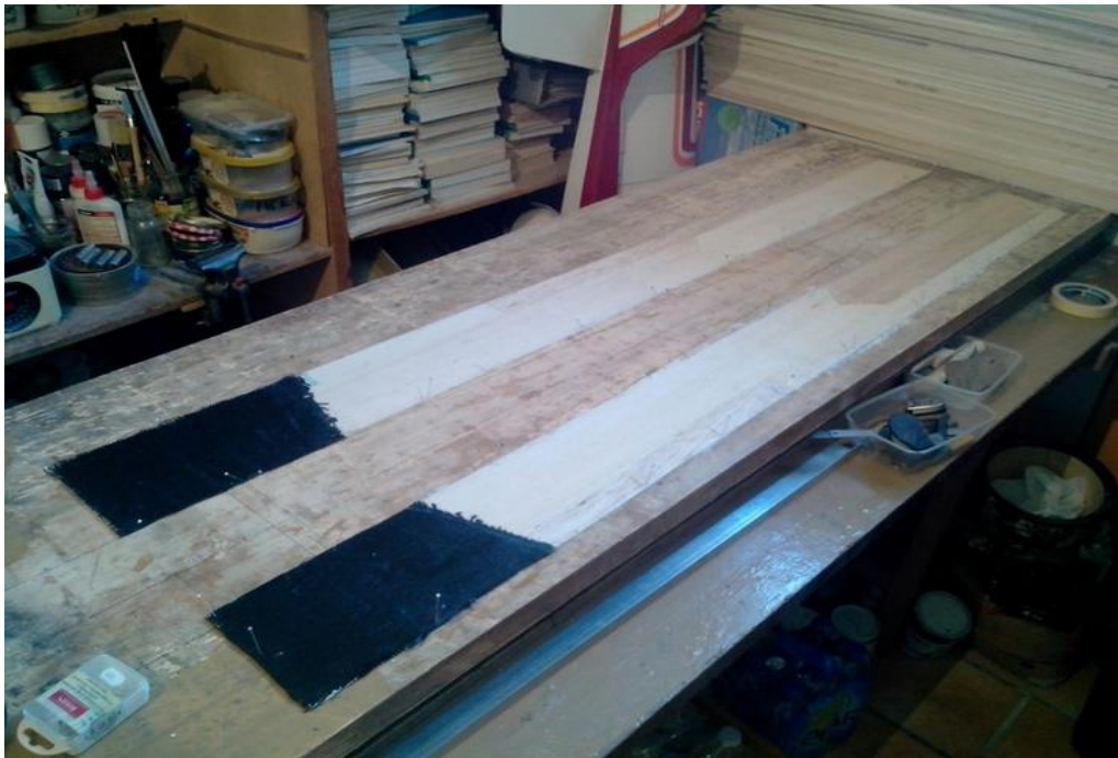
Les pièces sont recouvertes intérieurement de tissu de verre et carbone dont le grammage varie en fonction des efforts exercé sur la cellule.
