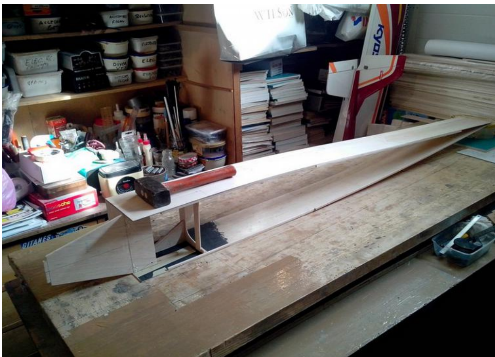
Les deux flancs sont assemblés sur des pièces provisoires qui vont servir de gabarit de fixation du capot avant.
