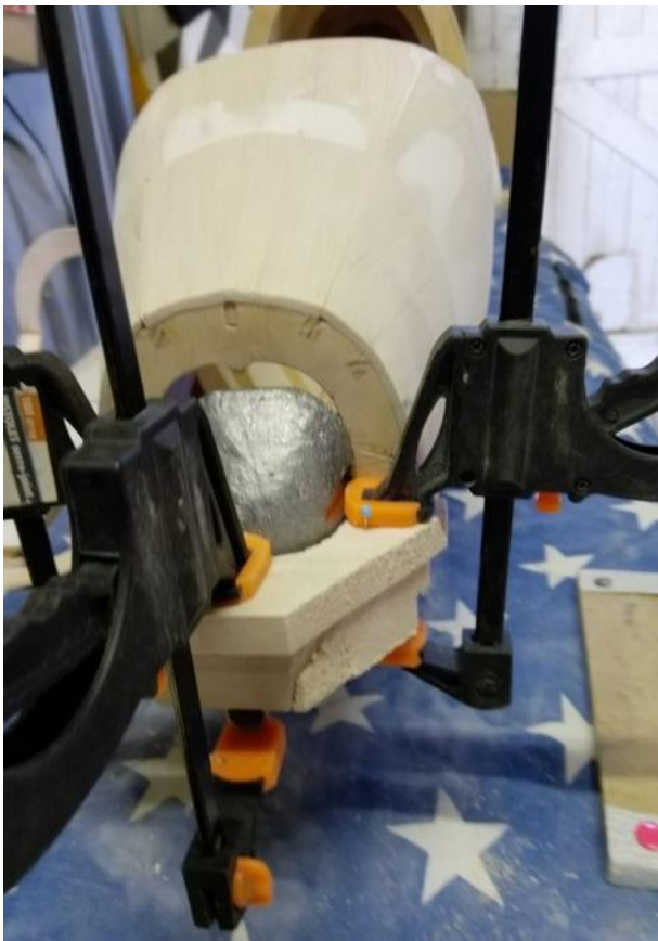
Confection du nez autour du lest. A noter que la moitié du lest est démontable (au cas où).
