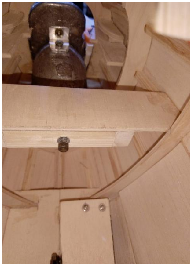
Confection du nez autour du lest. A noter que la moitié du lest est démontable (au cas où).
