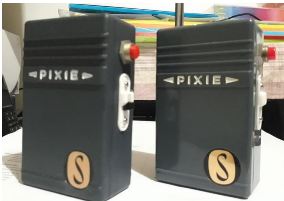
Une copie du boîtier réalisé avec FreeCad a gauche et l'original à droite.
