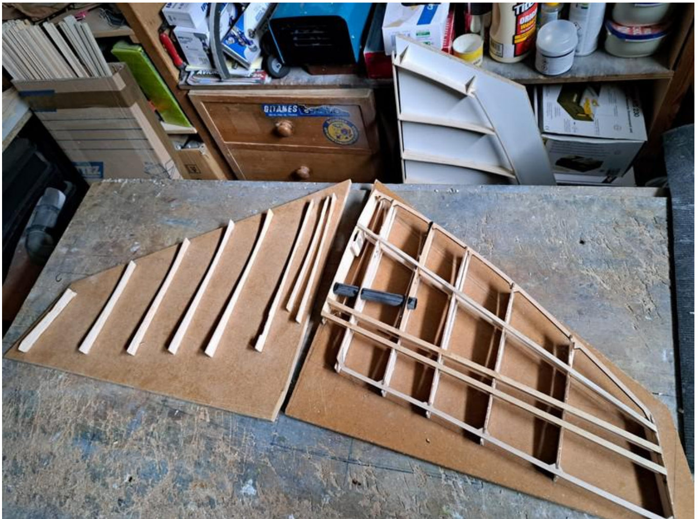
Le stabilisateur en cours de montage.
