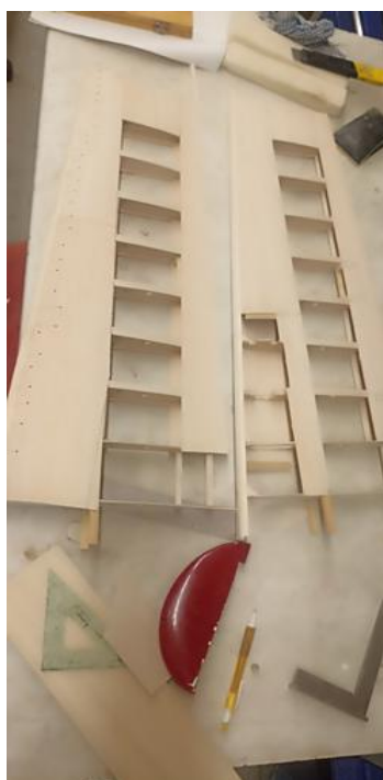
Premières ébauches, puis gabarits de ces bip de nervures de bip terminées
