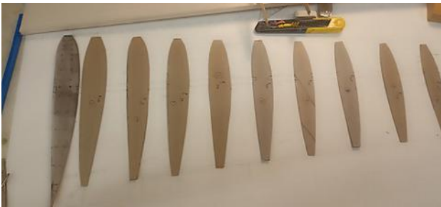
Premières ébauches, puis gabarits de ces bip de nervures de bip terminées
